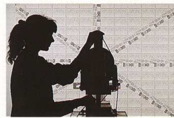
Contrôle de qualité permanent: Vérification des objectifs par rotation axiale et radiale, en fin de fabrication.
