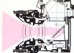
Schéma du faisceau lumineux dans le LEICA R - en mesure intégrale à grand champ et du champ de mesure dans le viseur.
