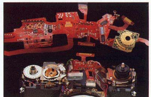
Une électronique élaborée selon la technique SMD se distingue par sa fiabilité, même dans les conditions d'utilisation les plus rudes.
