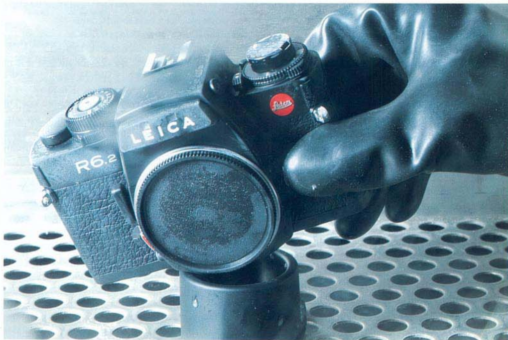
Chaque appareil est soumis en plusieurs cycles à un test climatique très sévère : de -25^{\circ}\text{C} à +60^{\circ}\text{C} .
